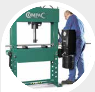
Pumpeenheden kan svinges 90 grader væk fra pressen.
