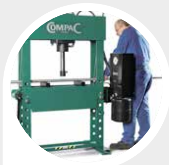
Pumpeenheden kan svinges 90 grader væk fra pressen.
