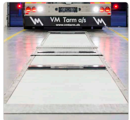
Rammeløsning Ramme leveres separat, løftesøjler og styring eftermonteres
